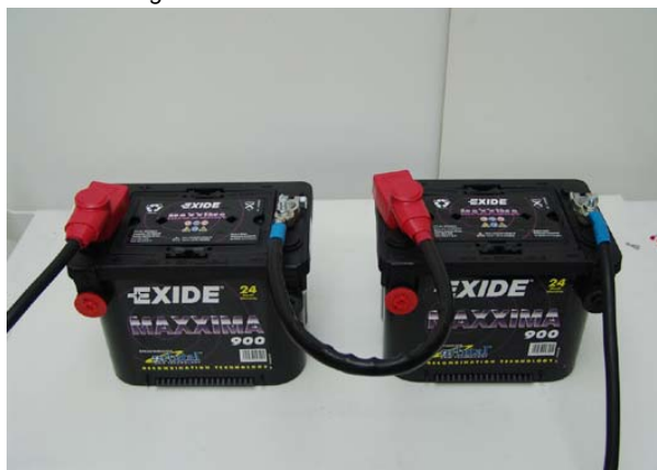
Fig. 6.12.2-4: Installation starter batterie
